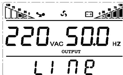
**Carga:** Exibe o valor da potência útil (WATT) e da potência aparente (VA) da carga
