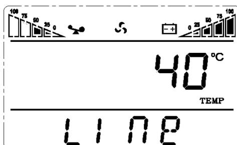
**Rede:** Exibe a tensão e frequência da rede elétrica.
