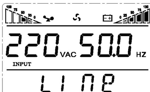
**Bateria:** Exibe a tensão e o percentual de carga do banco de bateria.
