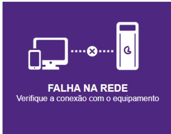
Quando o **LogBlueWeb** não consegue comunicar com o navegador web será exibida uma página com o erro da imagem “FALHA NA REDE”. Na maioria dos casos este problema é causado por interferências no link de comunicação ethernet com o **LogBlueWeb**, como por exemplo a desconexão do cabo de rede e problemas na infra de TI.
