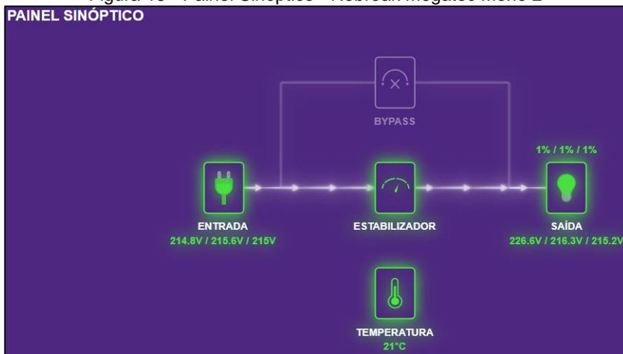
Figura 16 - Painel Sinóptico - Estabilizador Trifásico
