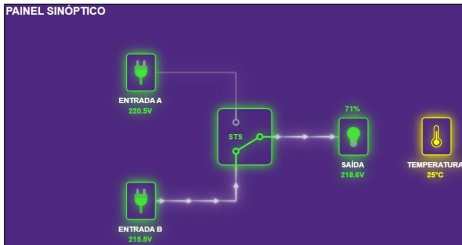
Figura 17 - Painel Sinótico - Chave de Transferência STS
