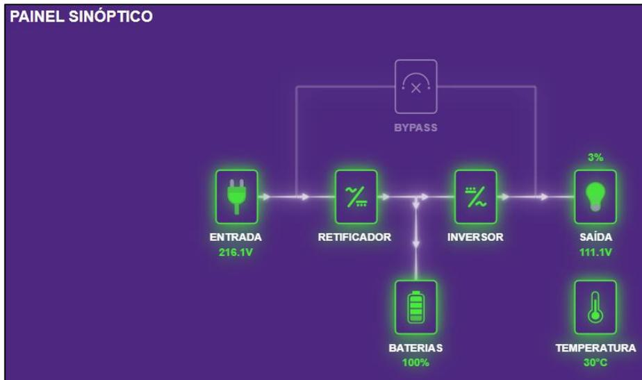
Figura 15 - Painel Sinóptico - Nobreak Megatec Mono 2
