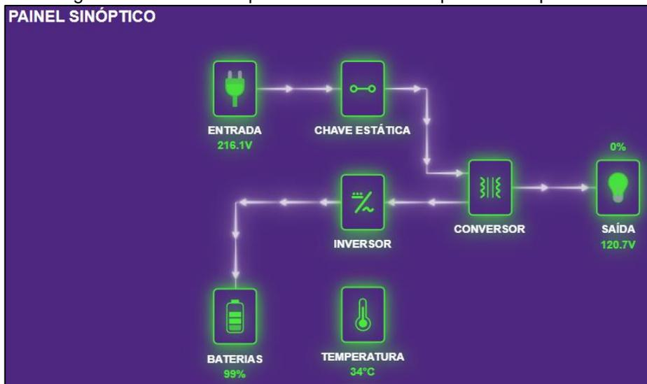
Figura 14 - Painel Sinóptico - Nobreak Vipmaster protocolo Vipmaster
