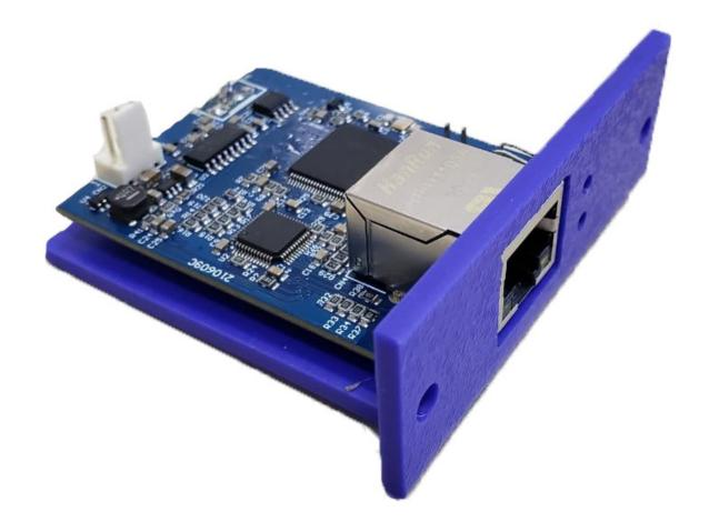
O LogAgent é um dispositivo de comunicação cujo FIRMWARE possui todos os protocolos de comunicação da arquitetura TCP/IP e os protocolos de comunicação com os Nobreaks da linha Logmaster. Estes protocolos têm a funcionalidade de obter e enviar os dados dos Nobreaks, mas não tem incumbência de exibir os dados ou capturar as novas configurações registradas pelo usuário. Para às duas últimas tarefas, é necessário utilizar o LogBlueWeb.
